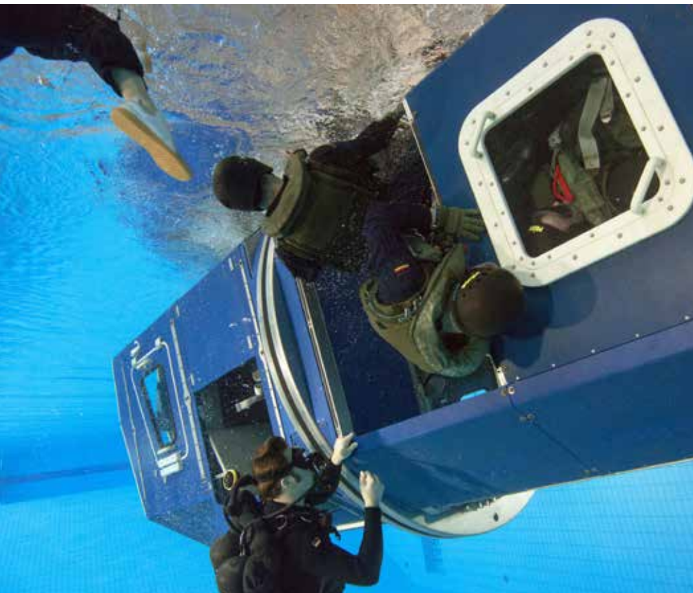
Ausstieg unter Wasser aus dem über Kopf stehendem Modular Egress Training Simulator (METS)
